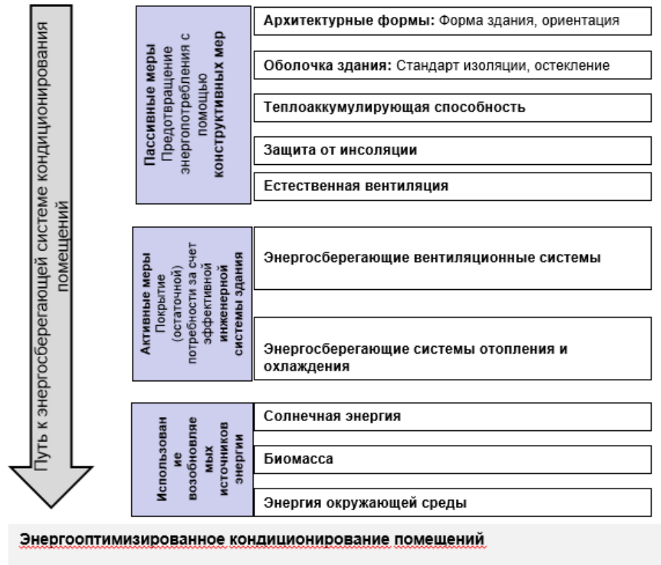
Рис. 2: Мероприятия по энергетическому кондиционированию помещений 1
