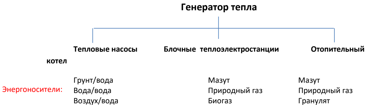
Рис. 6: Обзор распространенных теплогенераторов и подходящих источников энергии (Хайнер (2010 г.) 4 )
