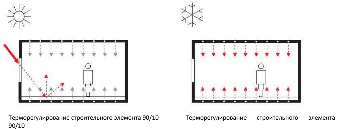
Рис.11: Рассеивание тепла и холода посредством активации компонентов 25
